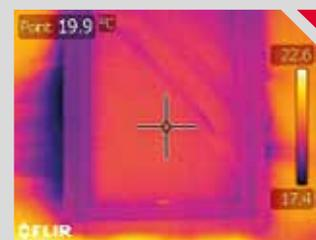
En effet, l'air extérieur, s'il est suffisamment « froid » par rapport à celui de l'intérieur, en passant par une fissure, un mauvais joint, un mauvais raccord, « refroidit » les surfaces sur lesquelles il passe. Il laisse alors des traces caractéristiques, repérables par un opérateur formé à ces analyses.
