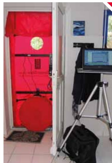
Des capteurs, implantés sur cet appareil, mesurent les pressions intérieures et extérieures, du volume testé.
